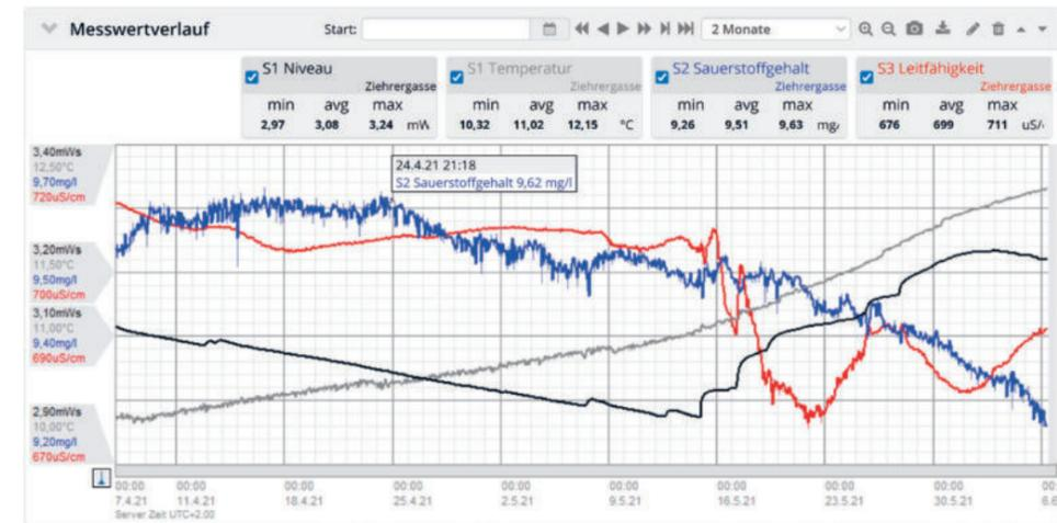
Darstellung eines Messwertverlaufes der Parameter Niveau, Temperatur, Sauerstoffgehalt und Leitfähigkeit. Die Auswertungszeiträume können flexibel eingestellt werden.
