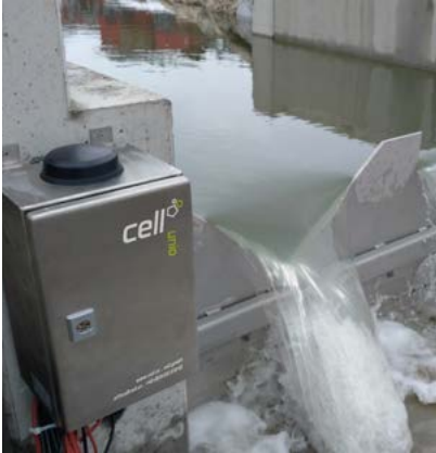
Fließgewässermessstelle mit Dreieck- und Rechteck- Kombinationswehr. Batteriebetrieb mit Durchfluss- und Temperaturmessung.
