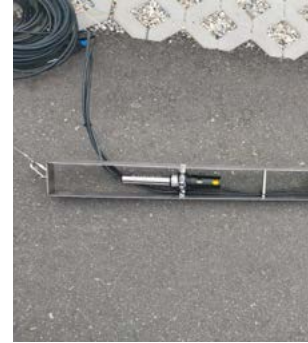
Stabile und erweiterbare Sonden-Abhängevorrichtung zum Einhängen in Grundwassermessstellen oder Brunnen
